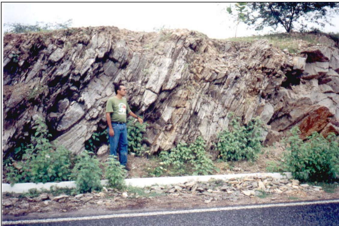
FOTO 08: Barragem Capitão-Mor - Idem foto anterior. Notar o Bandejamento/xistosidade do gnaíse, que apresenta cisalhamento (10/04/02).
